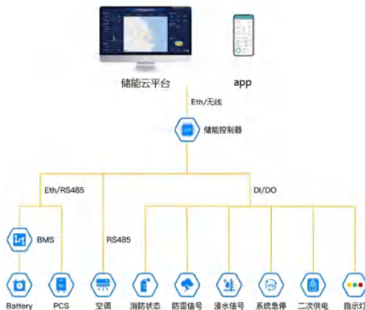
图 4 储能 EMS 架构示意图
