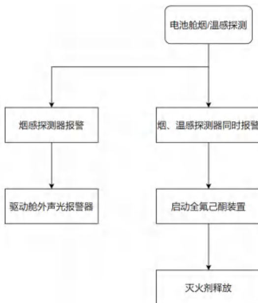
图 5 消防系统控制逻辑图
